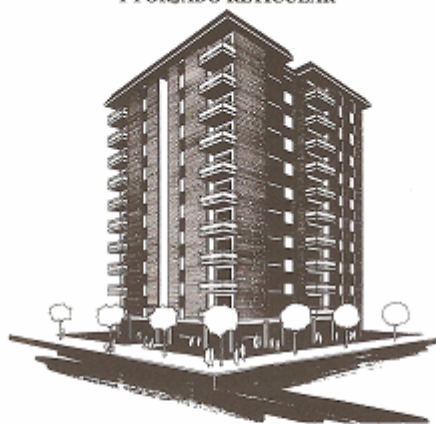
CASA DE RENTA TIPO SOCIAL CON ESTRUCTURA DE HORMIGON ARMADO Y FORJADO RETICULAR
